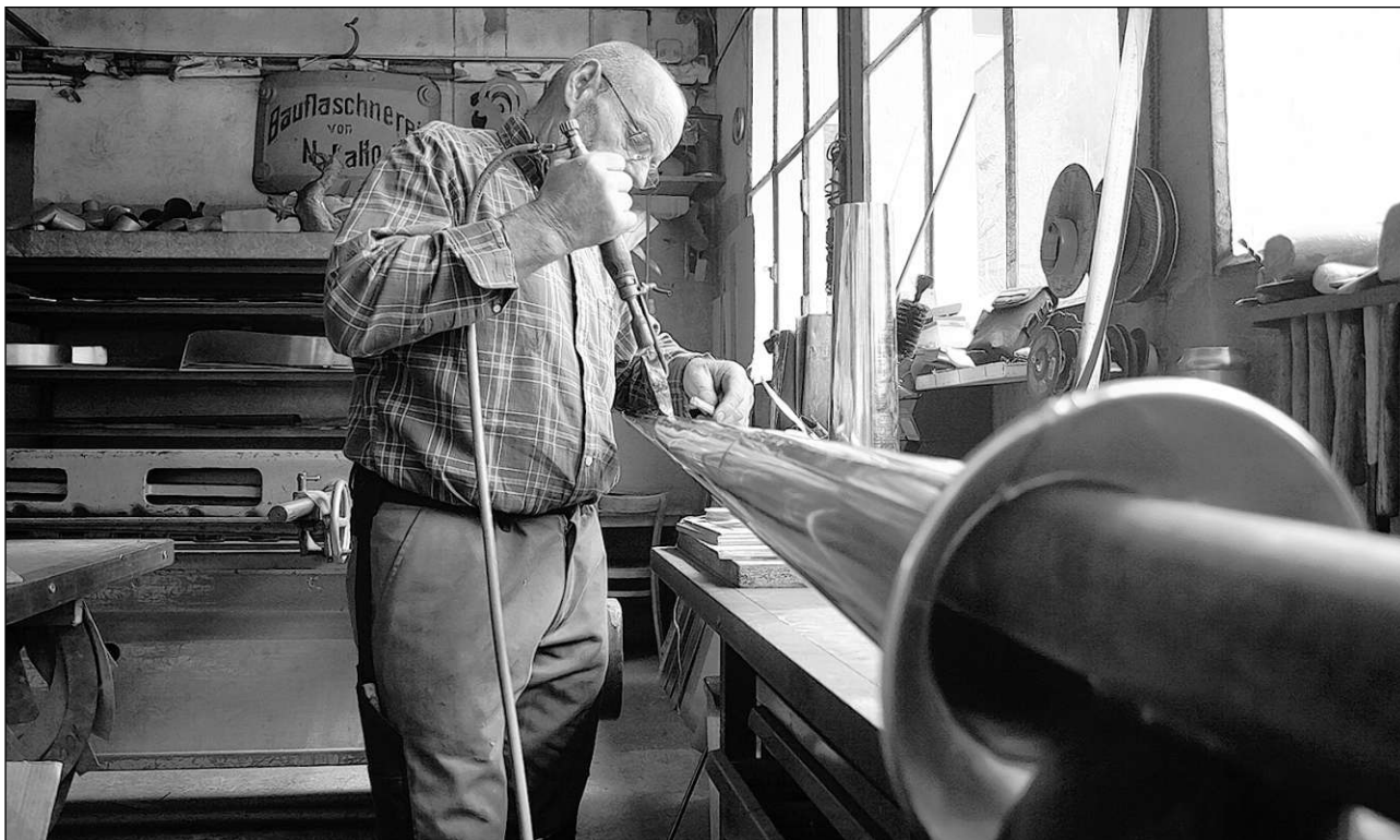
Avant che bugliar ensemen la tocca èsi da metter si grass. En tut dovra Marcel Bass quatter uras per ina tiba.
