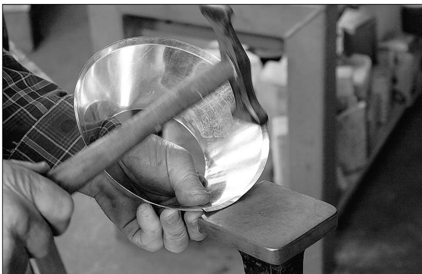
Il conus dovra pazienza ed inschign. En l'ur vegn enzuglià in fildarom per enfirmir il toc oradim.
